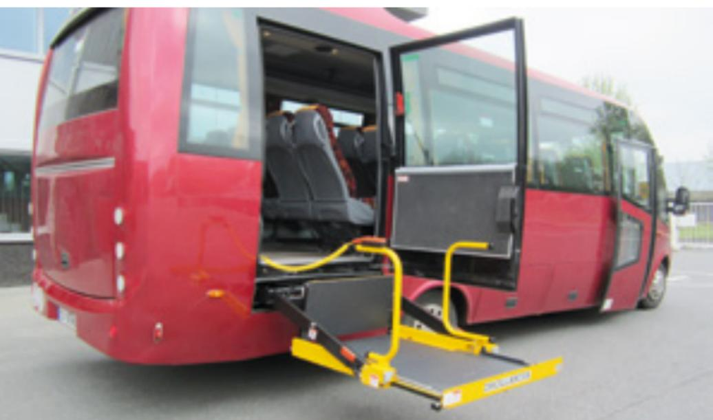
Rispetto alle DH-CH.100...103, la DH-CH.002 e -CH.003 sono dotate di piattaforme **estensibili**, che **riducono lo spazio di montaggio** richiesto significativamente sotto o all'interno del veicolo.
